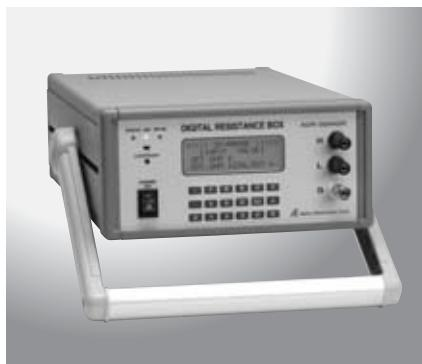
デジタル式精密可変抵抗器は、パソコンから抵抗値を切り替え可能な精密可変抵抗器です。これまでのダイヤル式抵抗器に代って検査の自動化が可能となり、検査時間・人為的ミスの大幅削減を実現し、模擬入力抵抗を切換える検査や試験に最適な製品です。本体パネルのテンキーからの抵抗値設定も可能です。また、白金測温抵抗体JIS規格(JIS C1604/IEC60751)データを内蔵しており、温度での入力も可能です。
